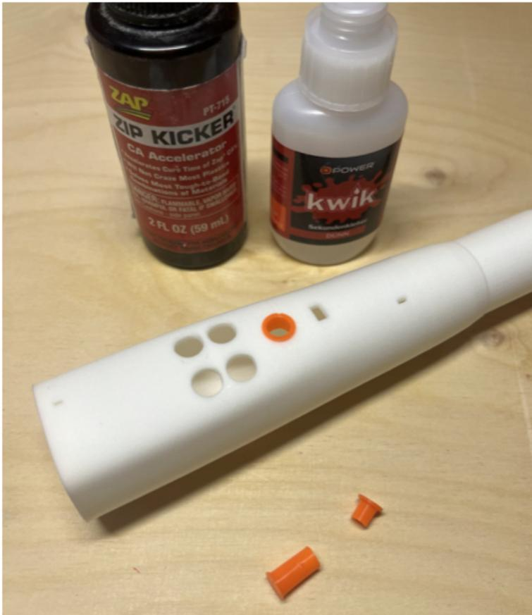
Der Kragen wird in die Öffnung mit CA eingeklebt.
