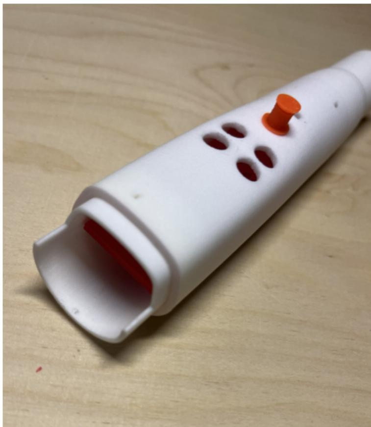
Fertig, die Platine ist bis zum Anschlag eingeschoben, die 4 Öffnungen liegen genau über die Trimpoti.
