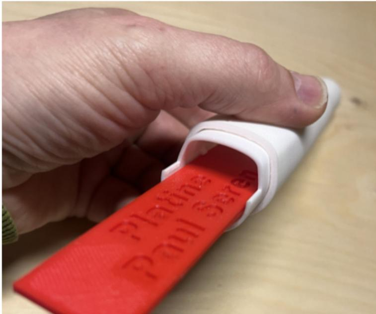
Das Einschieben der Platine muss mit eingesetzten Klebeadapter erfolgen.
